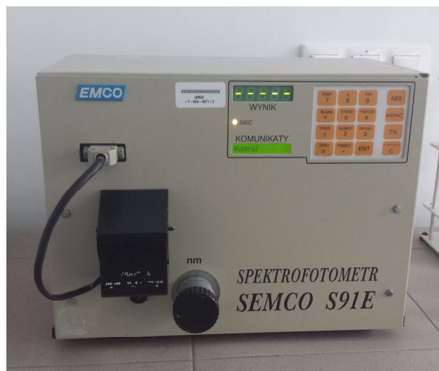
Rys. 2. Spektrofotometr UV-Vis SEMCO S91E
